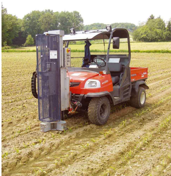
Obrázek - Použití mobilního přístroje pro odběr půdních vzorků na orné půdě
