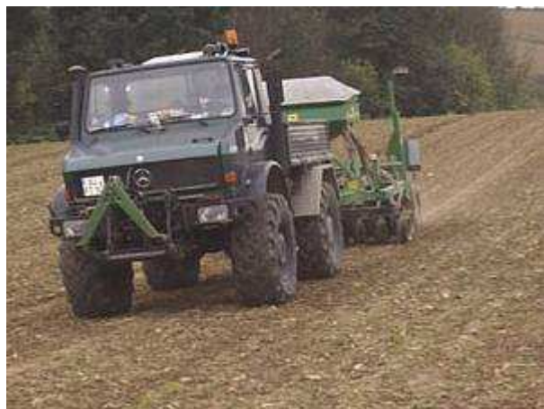
Obrázek - Služby pro členy: Secí stroj pro přímý výsev obilovin
