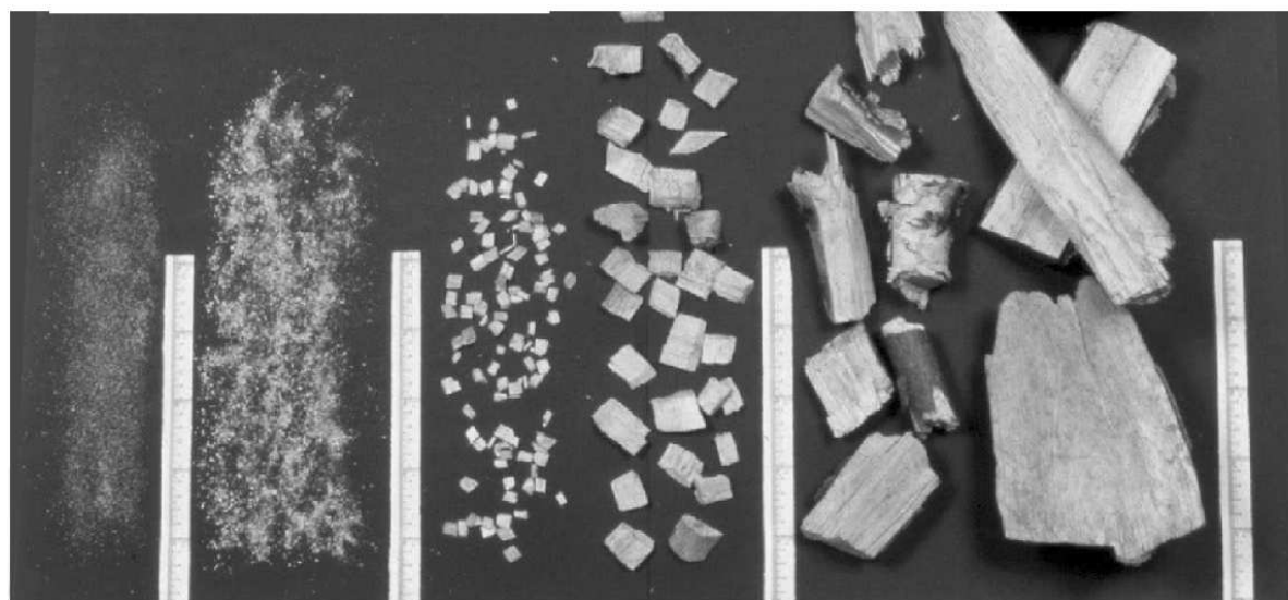
velikost částic mm 1 5 jemné (15) hrubé 50 kusy dřeva (150) palivové dřevo 500 mm dřevní prach+---piliny---+-----dřevní štěrky-----+-----malé dřevo-----+---celé dřevo
